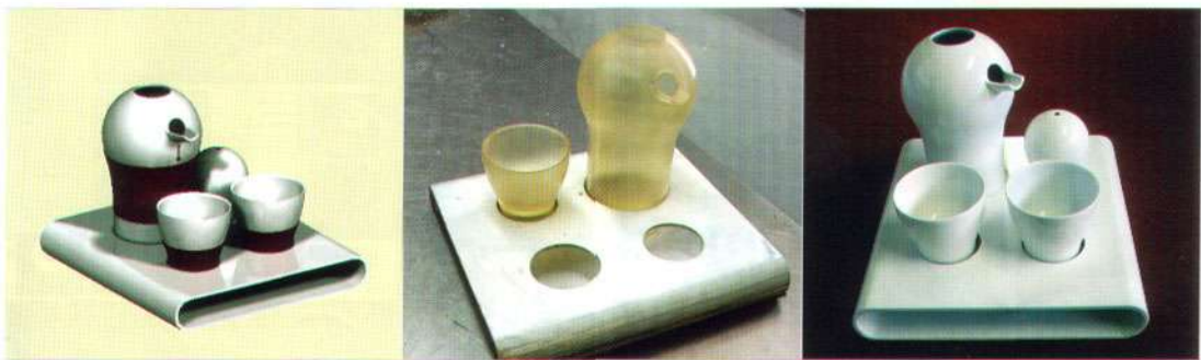
■ O INEGI apresenta diversos produtos fabricados a partir de prototipagem rápida, como este serviço de chá
